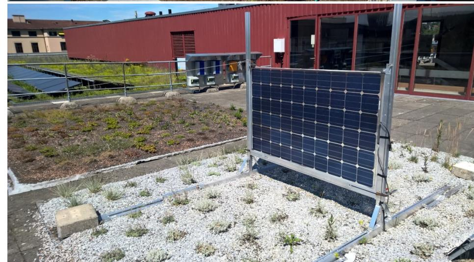
Ertragsforschung von bifacialen senkrechten Solaranlagen; unter Berücksichtigung des Bewuchses unter den Panels und in verschiedenen Breitengraden
